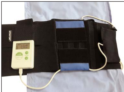
Рис. 13. Свободный кабель подключается к разъему VM аппарата «Витафон-5».
