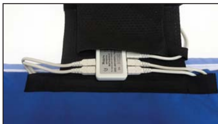
Рис. 15. Присоединение шнуров к модулю-разветвителю.
